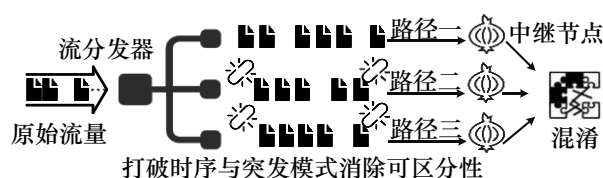
图7 多路径分散型防御原理图
